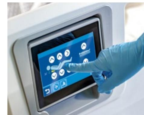
**IT** ATLANTE dispone di una console touchscreen e una console fisica con tastiera illuminata a LED. I pannelli permettono di controllare facilmente i comandi mentre si lavora da qualsiasi posizione e in qualsiasi posizionamento del letto.
